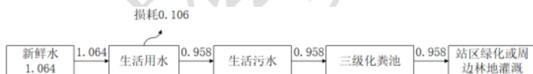
图 2-1 项目水平衡图（单位：m 3 /d）
