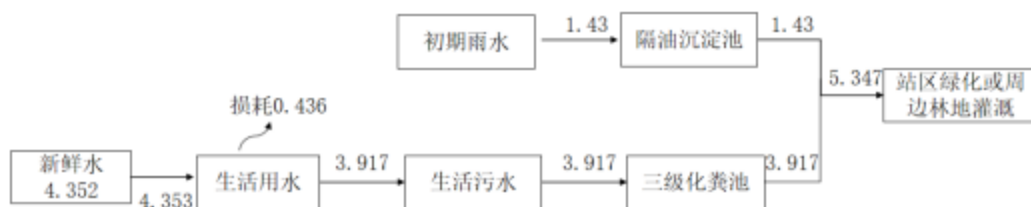
图 2-2 项目建成后全站水平衡图（单位：m 3 /d）
