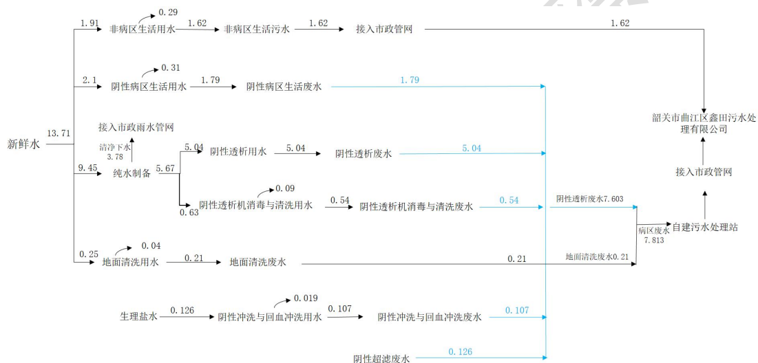
图 5 项目水平衡图 (m³/d)
