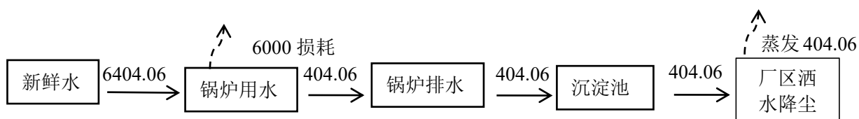
图 2-1 本项目水平衡图 单位 \text{m}^3/\text{a}
