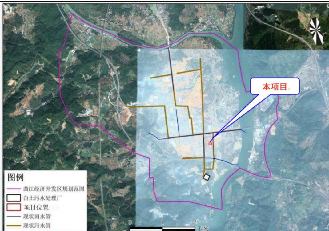
图 4-1 本项目与园区污水管网位置关系图
