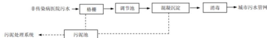
图 7 非传染病医院污水一级强化处理工艺流程
