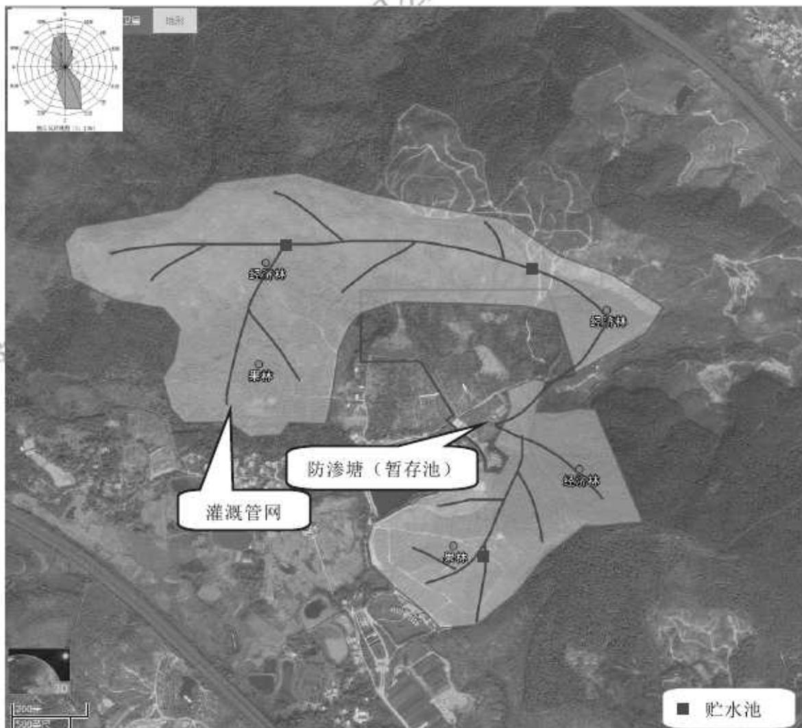
图 6-1 灌溉管网布置示意图
